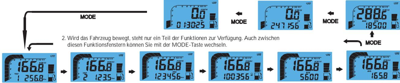
2. Wird das Fahrzeug bewegt, steht nur ein Teil der Funktionen zur Verfügung. Auch zwischen diesen Funktionsfenstern können Sie mit der MODE-Taste wechseln.
